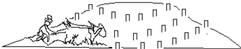
FIGURA 3-11: Un terreno en la ladera de un cerro, con tres líneas de contorno estaqueadas representando cursos de badenes. El arado tirado por bueyes está aflojando el suelo por el curso del badén.
